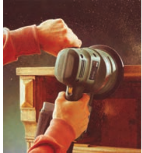
شکل ۲۰-۱۱- پرداخت سطح کار.
