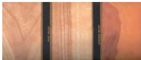
شکل ۲۴-۱۰ چوب ملج در سه برش عرضی، شعاعی، مماسی.
