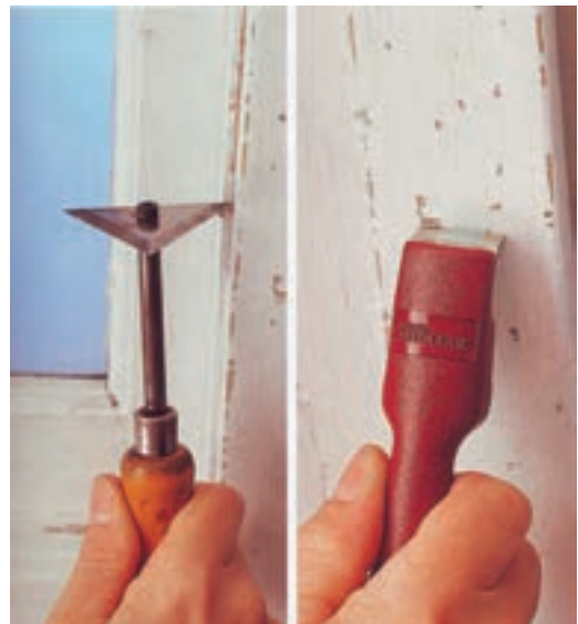
شکل ۲۵-۱۱ تجهیزات پرداخت و رنگزدایی از سطح چوب.
