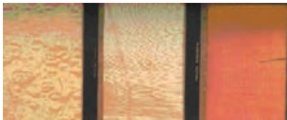
شکل ۲۷-۱۰ چوب افرا در سه برش عرضی، شعاعی، مماسی.
