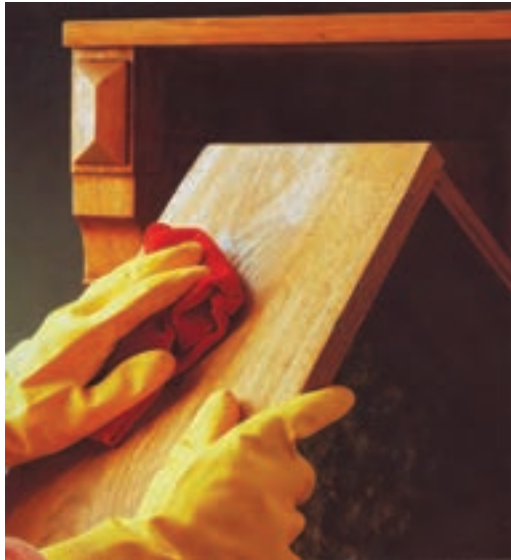
شکل ۲۲-۱۱- پاک کردن سطح کار پس از آستری.
