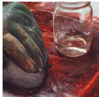
شکل ۳۵- ۱۱- پرداخت سطح کار با سیم ظرفشویی.
