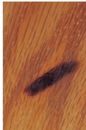
شکل ۱۱-۱ اثر اکسیداسیون روی سطح.
